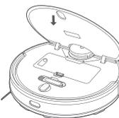
3. 2v1 zásobník na prach s nádržkou na vodu znovu vložte do robotického vysavače tak, aby správně zapadl na své místo, a poté zavřete robotického vysavače.
