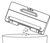
2. Vyprázdněte zásobník na prach. Zásobník vyčistěte pomocí čistícího kartáče, poté srovnejte a znovu vložte filtr.
