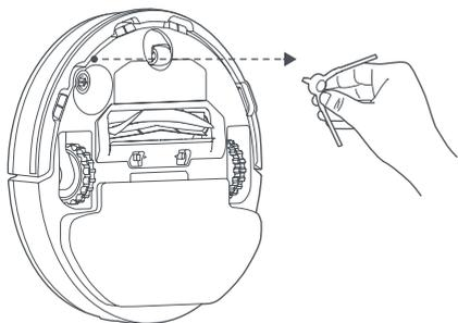
Bočnú kefu pravidelne vyberajte a čistite. Bočnú kefu odporúčame meniť každých 3-6 mesiacov, aby sa zaistila optimálna účinnosť čistenia.
