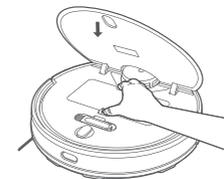
4. Zásobník na prach znova vložte do robotického vysávača tak, aby dobre zapadol na svoje miesto, a potom zatvorte kryt vysávača.
