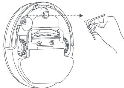
Boční kartáč pravidelně vyndávejte a čistěte. Doporučujeme každých 3-6 měsíců boční kartáč vyměnit, aby byla zajištěna optimální efektivita čištění.
