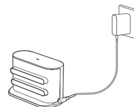
3. Nabíjaciú stanicu položte na rovnú zem oproti stene.
