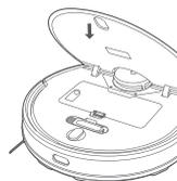
3. 2x1 zásobník na prach s nádržkou na vodu znova vložte do robotického vysávača tak, aby dobre zapadol na svoje miesto, a potom zatvorte kryt vysávača.
