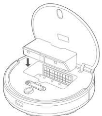
1. Otvorte kryt robotického vysávača a vložte zásobník na prach alebo 2v1 zásobník na prach s nádržkou na vodu znázorneným smerom, dokým nezaklapne na miesto
