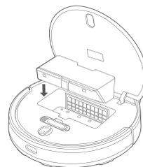
1. Otevřete kryt robotického vysavače a vložte zásobník na prach nebo 2v1 zásobník na prach s nádržkou na vodu znázorněným směrem, dokud nezaklapne na místo.
