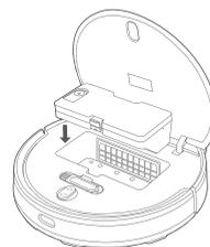
2. Vložte 2v1 zásobník na prach s nádržkou na vodu do robotického vysavače dokud nezaklapne na místo.
