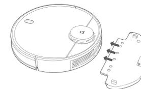
4. Pomocí západek připevněte držák mopu v horizontální poloze na spodní stranu robotického vysavače, viz obrázek.
