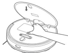
4. Zásobník na prach znovu vložte do robotického vysavače tak, aby správně zapadl na své místo, a poté zavřete kryt mopu.
