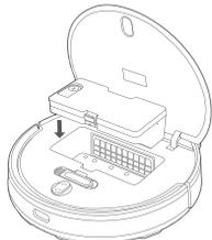
2. Vložte 2v1 zásobník na prach s nádržkou na vodu do robotického vysávača, dokým nezaklapne na miesto.
